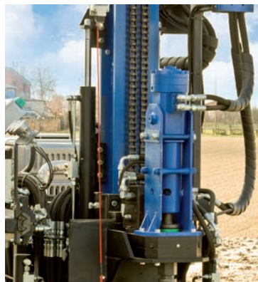
Particolare rotoperforatore a 2 motori e antenna idraulica allungabile (+2200 mm).
