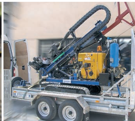
Le dimensioni compatte della perforatrice JOY 1 consentono di trasportarla con un carrello di piccole dimensioni
