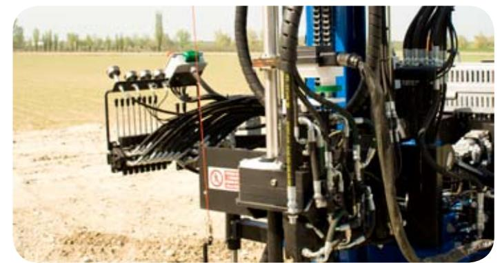
Le seul inconvénient des sondes VIBRASOND par rapport aux sondes traditionnelles, c'est que ce type de sonde ne peut pas être adopté dans les sols à dureté élevée (pierreux ou rocheux). Pour ce type de sol, Hydra fabrique une série de machines de perforation en mesure de réaliser des perforations jusqu'à 150-200 m de profondeur sur n'importe quel type de sol.
