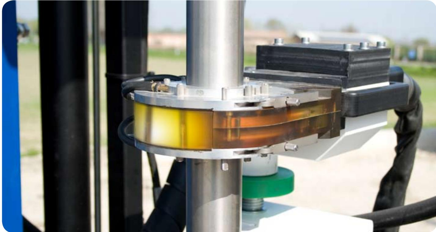
Ce kit de vibrofonçage peut être installé sur des machines de la série JOY qui sont normalement utilisées pour la réalisation de perforations de type traditionnel ; avec cette application, elles sont transformées en machines de vibrofonçage.
